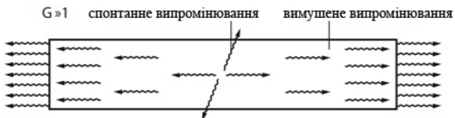
Рис. 1.6. Схема лазера без зворотного зв'язку
