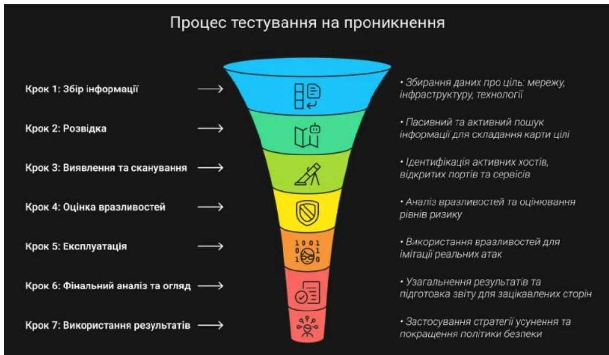
Рис 1.2 Кроки тестування на проникнення
