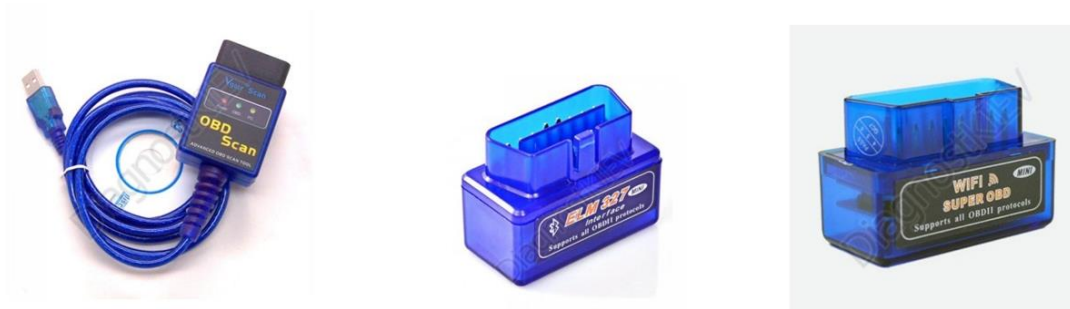
Рисунок 1.9 - Вид гаджетів-адаптерів OBD-II з різними способами підключення до зовнішнього пристрою
