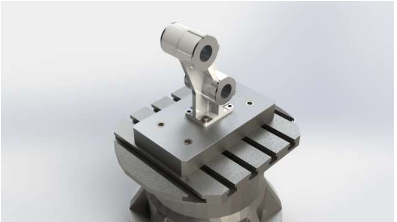
Рис.3.2.2 – Верстатний пристрій для операції 010
