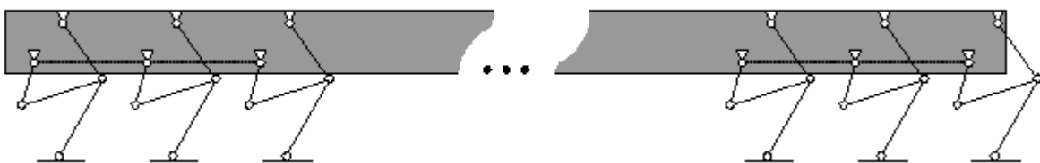
Рисунок 3.8. Схема машини з рушійми, що складаються з трьох механізмів
