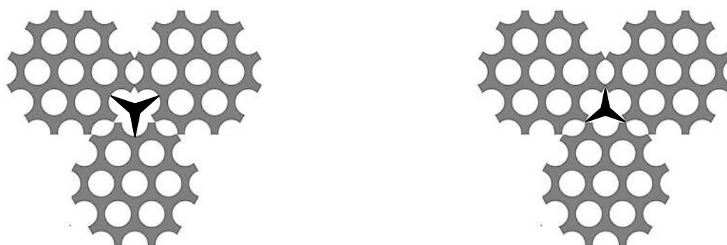
Рис. 2.11. Спосіб укладання регулярної насадки з елементів у вигляді правильної шестикутної призми (пат. № UA150574U)
