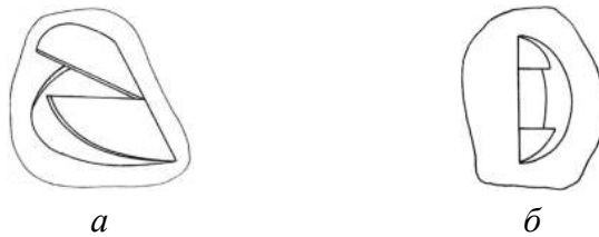
Рис. 2.141. Конструкція полотна тарілок згідно з а. с. № SU1000048A1 (а) і SU1053842A1 (б)
