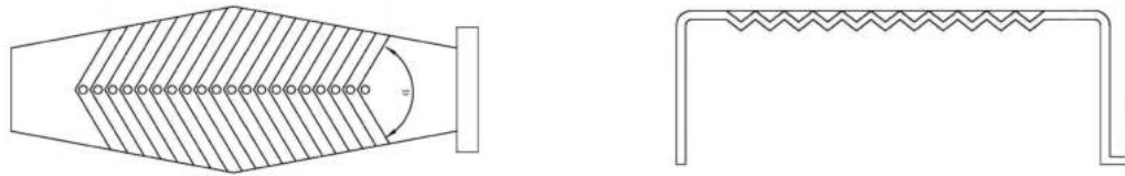
Рис. 2.122. Гофрований клапан згідно з пат. № CN203778075U
