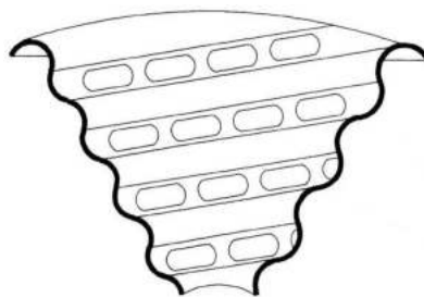
Рис. 2.35. Елемент насадки у вигляді гофрованого конуса (пат. № CN1843613A, CN2899929Y)
