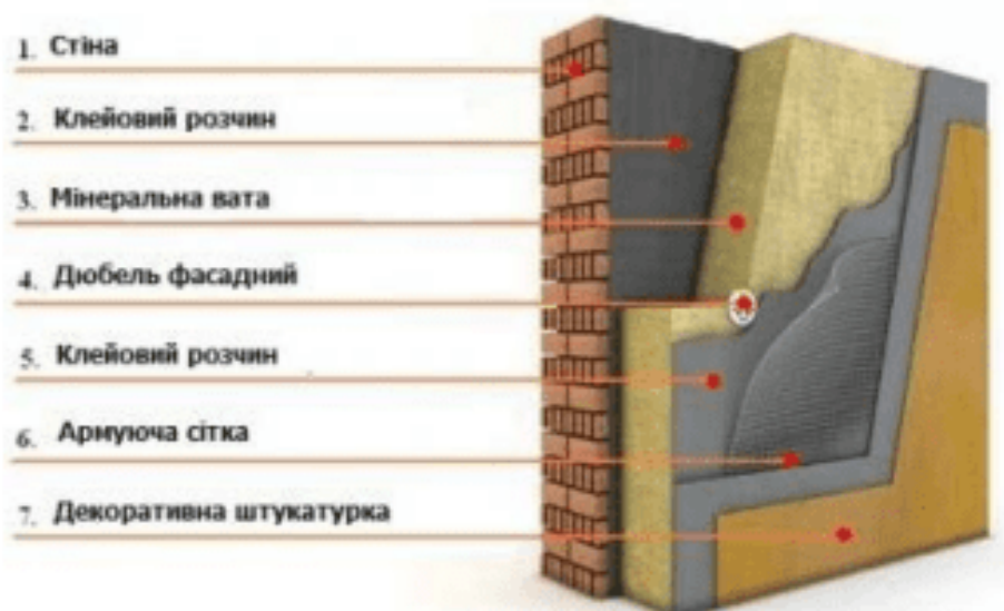
Рисунок 3.3 – Технологія утеплення зовнішніх фасадів
