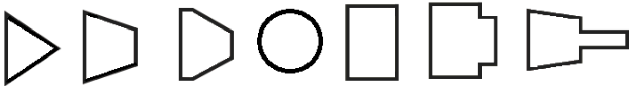
Рисунок 6.21 – Форми тіл обтікання вихрових витратомірів
