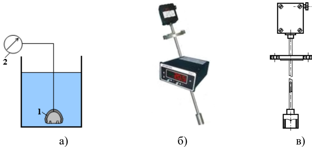
Рисунок 5.18– Схема гідростатичного дзвонового рівнеміра (а), промисловий дзвоновий рівнемір УГЦ-1.1 з цифровим вторинним приладом (б) і його схематичне зображення (в): 1 – дзвін; 2 – вимірювальний прилад (манометр)
