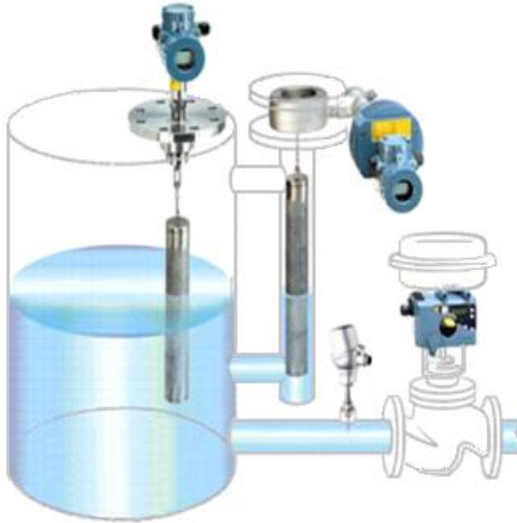
Рисунок 5.11 – Приклади розміщення промислових буйкових рівнемірів
