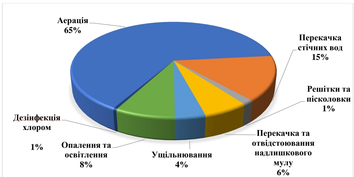
Рисунок 2.1 - Розподіл енергозатрат станції аерації
