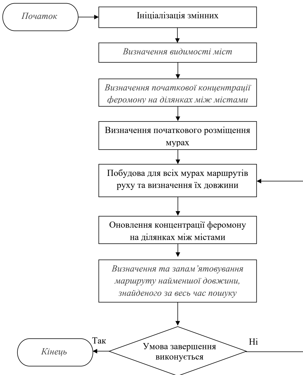
Рис. 19.10. Блок-схема методу мурашиної колонії для розв'язання задачі комівояжера (варіант)
