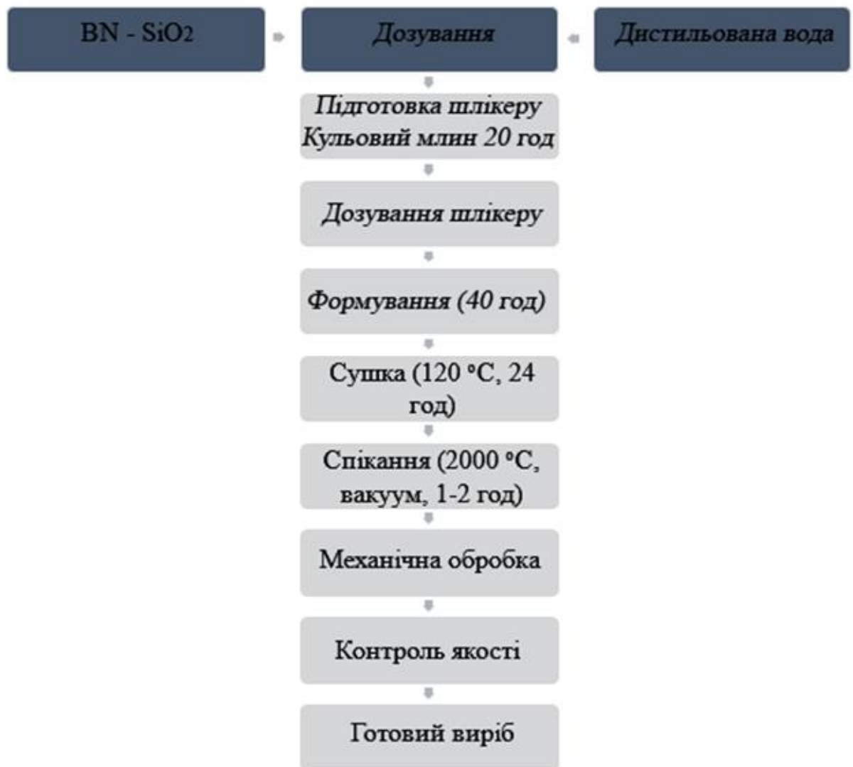
Рисунок 1.2 – Технологічна схема отримання деталі водним шлікером [1]
