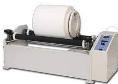
Рисунок 4.3 – кульовий млин IBMU-100-1 НТ Machinery
