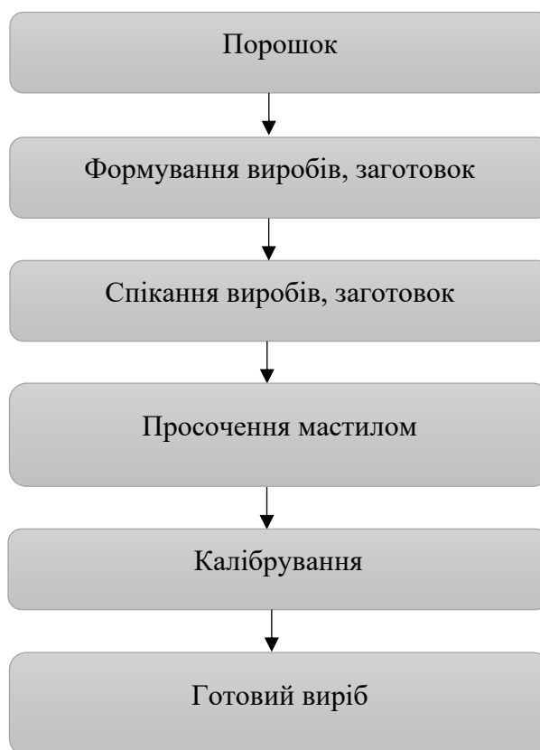
Рисунок 1.3 - Технологічна схема з використанням операції просочування мастилом
