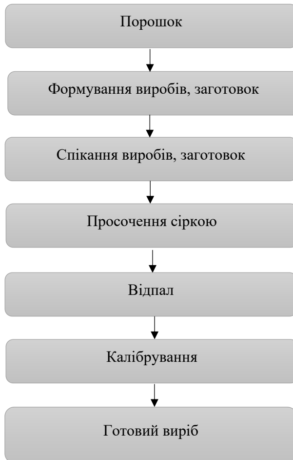
Рисунок 1.5 - Технологічна схема з використанням операції просочення сіркою
