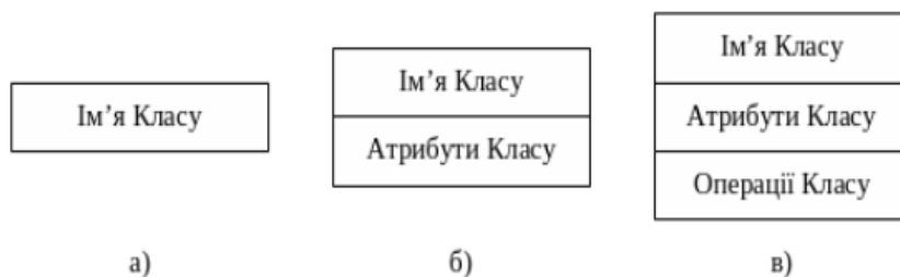
Рис. 11.1 Діаграми класу: а – ім'я класу; б – ім'я класу з доповнюючим атрибутом; в – ім'я з атрибутом та операцією
