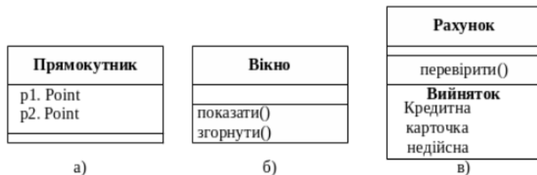
Рис. 11.2 Діаграми класу: а – клас «Прямокутник» з атрибутами; б - клас «Вікно» з операціями; в – клас «Рахунок» з відображенням винятку
