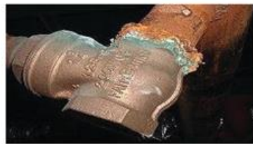
Рисунок 1.1 – Корозія щілини або корозія відкладення
