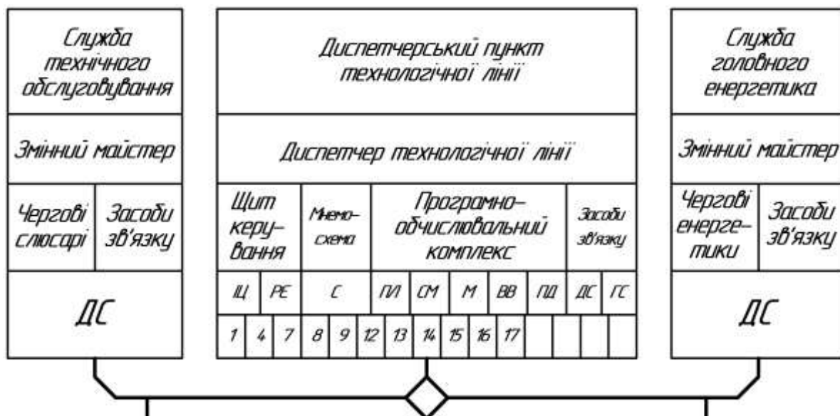
Рисунок 3.5 – Структурна схема автоматизації. Фрагмент. Верхній рівень ієрархії системи автоматизації. Приклад.
