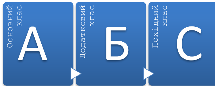
Рис. 8.3 - У багаторівневому успадкуванні ознаки базового класу та похідного класу далі успадковуються в новий похідний клас
