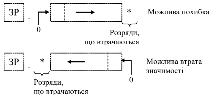
Рис. 1.4. Операційна схема арифметичного зсуву чисел у ПК
