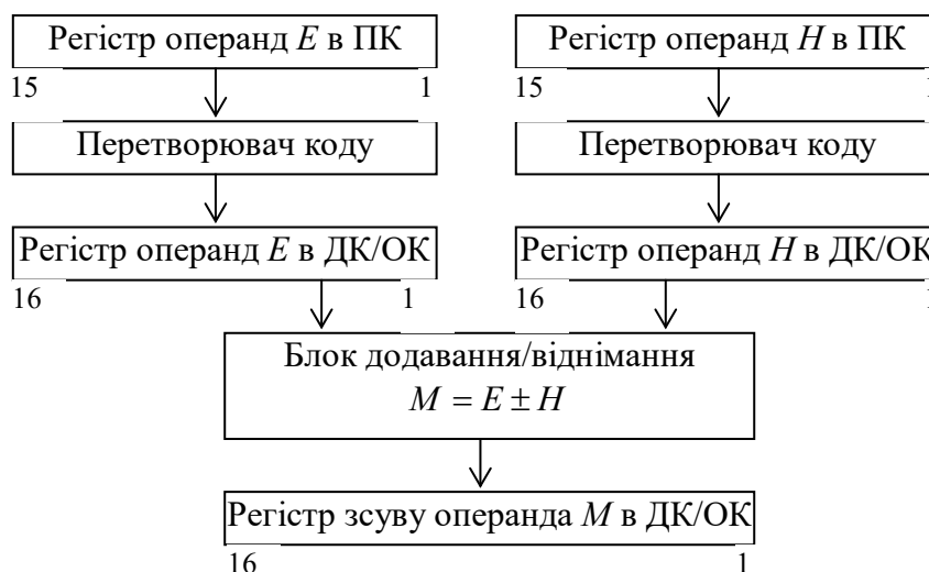
Рис. 1.14. Операційна схема пристрою
