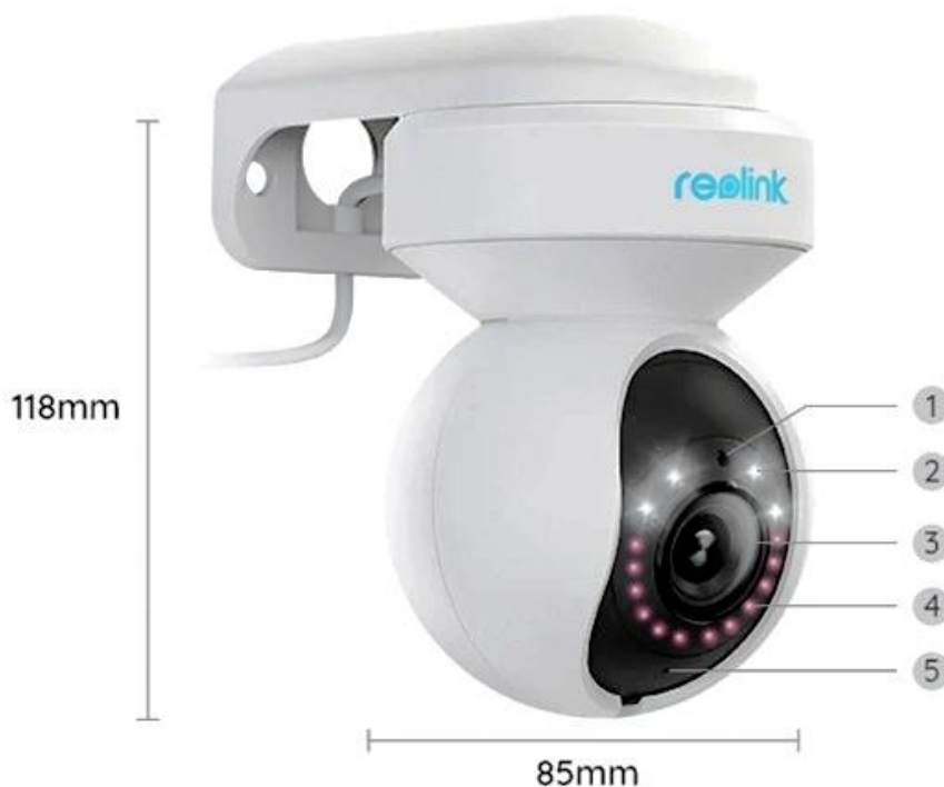
Рисунок 28 – Камера Reolink E1 Outdoor PoE: 1 – сенсор освітлення; 2 – світлодіодні прожектора кольорового нічного бачення; 3 – варіофокальний об’єктив; 4 – світлодіоди прожектора інфрачервоного підсвічування; 5 – індикатор статусу камери [11]
