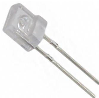
Рисунок 34 – світлодіод IR928-6C-F (Everlight) з довжиною хвилі випромінювання 940 нм [16]
