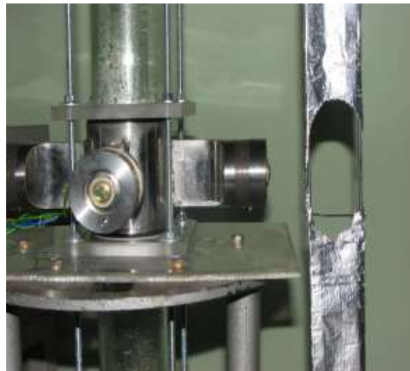
Рис. 1.45 – Експериментальна установка для дослідження поширення ультразвукової кавітації вздовж трубопроводу (а - загальний вид обладнання, б - розташування індикаторної фольги вздовж трубопроводу, в - область кавітаційного руйнування індикаторної фольги.)
