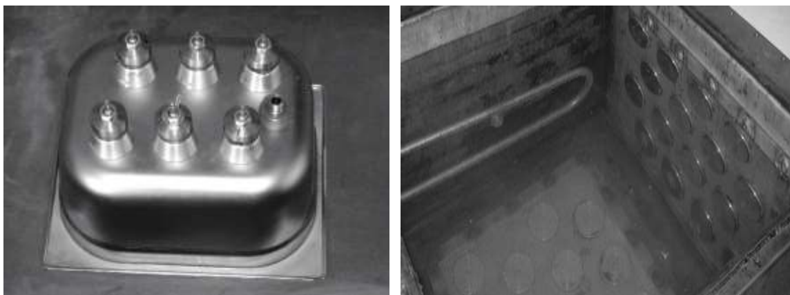
Рис. 1.8 – Кавітаційна ванна з \frac{1}{2} - хвильовими резонансними приводами- випромінювачами на донній поверхні (а) та всіх поверхнях (б)
