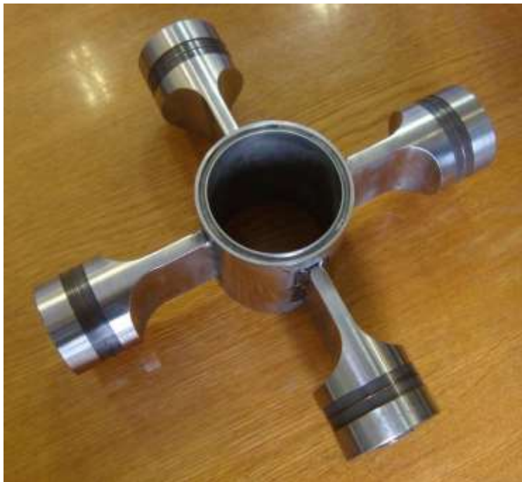
Рис. 1.36 – Ультразвуковий трубчастий кавітатор з радіальною модою коливань
