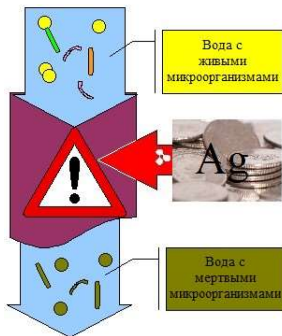
Рис. 1.5 – Схема знезараження рідкого середовища способом насичення іонами срібла
