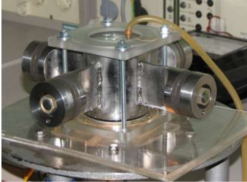
Рис. 1.37 – Експериментальна установка для дослідження роботи ультразвукового трубчастого вібратора
