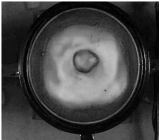
Рис. 2.17 – Концентрація ультразвукового поля в циліндричній камері при збудженні радіальної моди коливань
