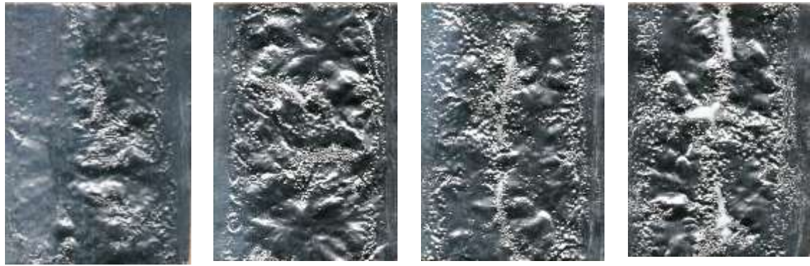
Рис. 2.51 – Зміна площі кавітаційного руйнування тестової фольги при різних рівнях пониженого тиску
