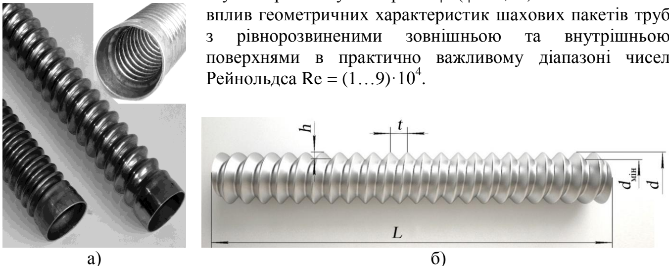
Рис. 1. Загальний вигляд (а) та геометричні характеристики (б) досліджених труб ( L – довжина труб; d , d_{\min} – внутрішні максимальний, мінімальний діаметри труби, що утворені гвинтовим виступом; h – висота виступу; t – відстань між сусідніми виступами)
