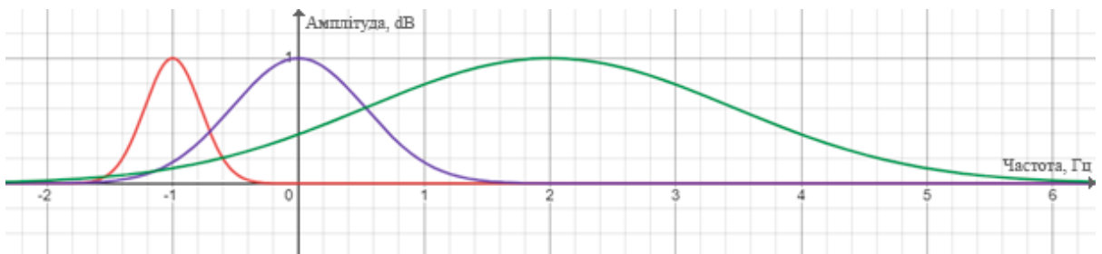
Рисунок 3.7 – Графіки функції смугового фільтра з різними налаштуваннями ширини діапазону та цільовою частотою
