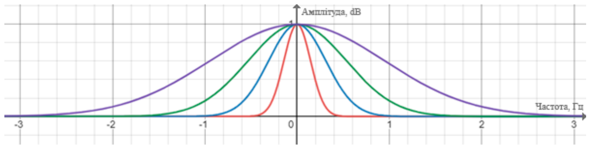
Рисунок 3.6 – Графіки функції смугового фільтра з різними налаштуваннями ширини діапазону
