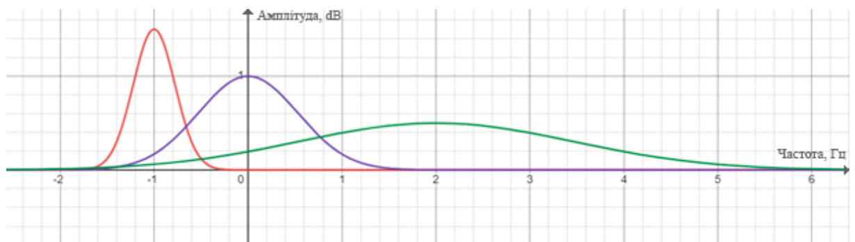
Рисунок 3.8 – Графіки функції смугового фільтра з різними налаштуваннями ширини діапазону, цільовою частотою та значенням посилення
