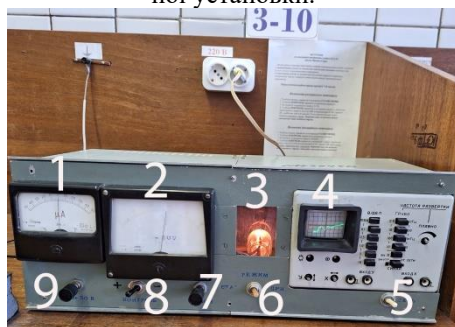
Рис.5. Лабораторна установка. 1 – мікроамперметр; 2 - вольтметр; 3 – електронна лампа; 4 – осциллограф; 5 – вимикач; 6 – вибір режиму роботи; 7 - регулятор запірної напруги U_3 ; 8 - перемикач вольтметра; 9 - регулятор напруги прискорення електронів U .
