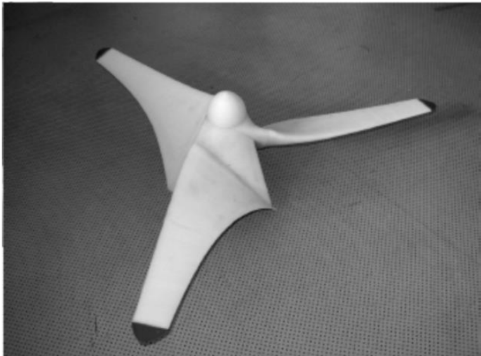
Рис. 1.17. Геометрія лопатей зі скруткою
