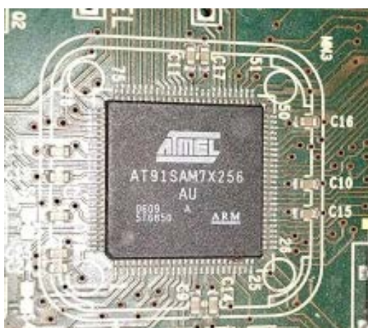
Рис.2.1. МК AT91SAM7X256 на відладочній платі
