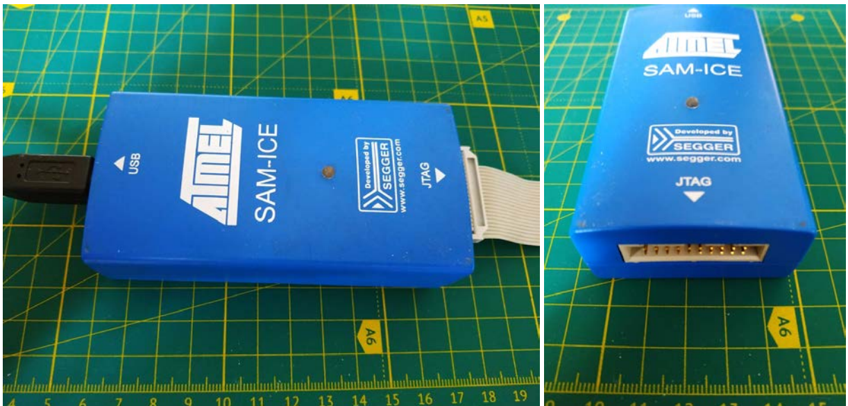
Рис. 1.5. Програматор Segger SAM-ICE: а) Загальний вигляд; б) Інтерфейс JTAG
