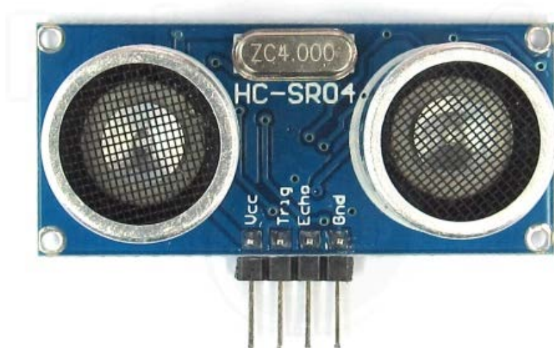
Рис. 12.1. Загальний вид чутливого елемента ультразвукового дальноміра
