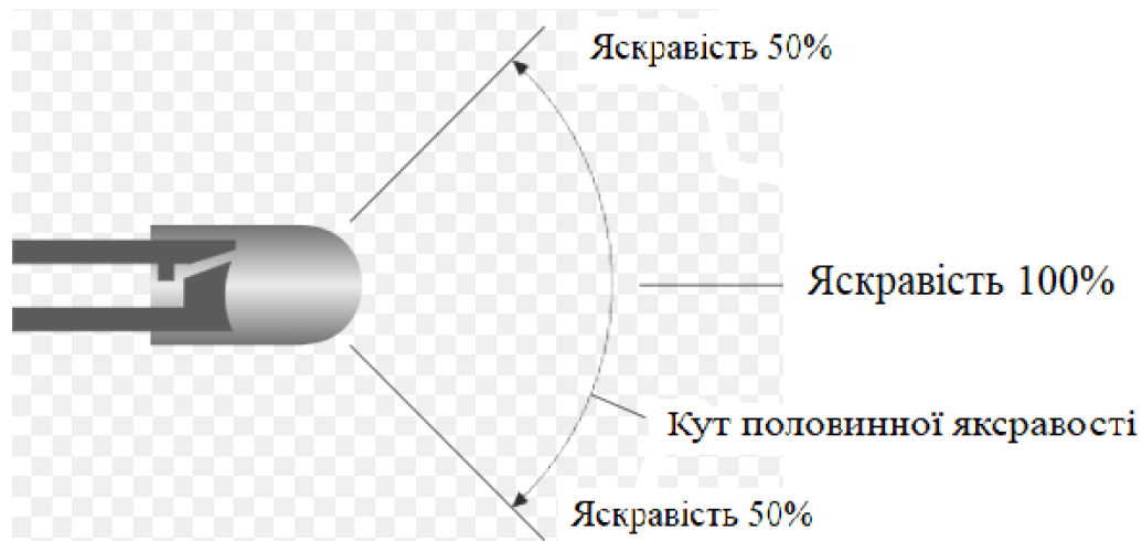
Рисунок 2.7 – Візуальне представлення максимальної та половинної зони освітлення світлодіода
