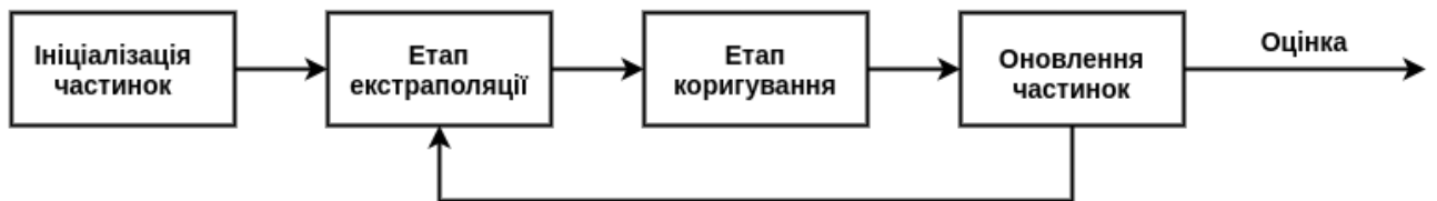
Рисунок 1.2 Узагальнений алгоритм фільтру частинок
