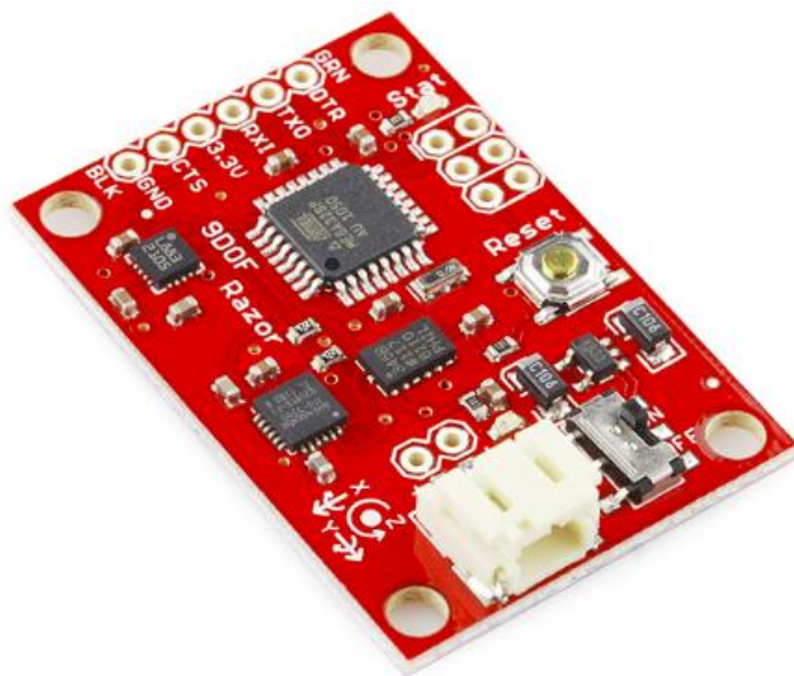
Рисунок 2.3 IMU з 9 степенями свободи від компанії Sparkfun
