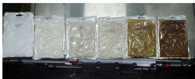
Рис. 1. Кріогелі з 0.00, 0.01, 0.05, 0.1, 0.5, 1.0 % вмісту \text{Ag}_2\text{O}
