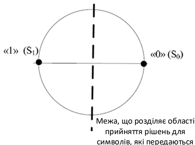
Рис. 3.5. Межі прийняття рішення в сигналі BPSK
