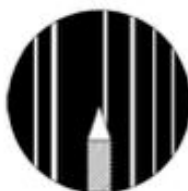
Вигляд поля зору окуляра з набором спектральних ліній і покажчиком
