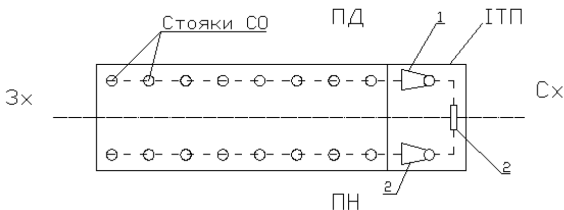
Рис. 2.17. Пофасадне регулювання опалення:
