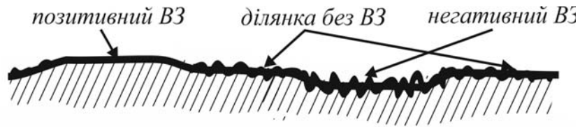
Рис. 2. Профіль поверхні паперу з водяними знаками
