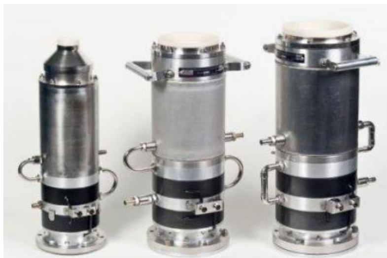
Рис.1.1 Газорозрядні електронно-променеві гармати ВТР-100 (100 кВт), ВТР-300 (300 кВт) і ВТР-450 (450 кВт) відповідно
