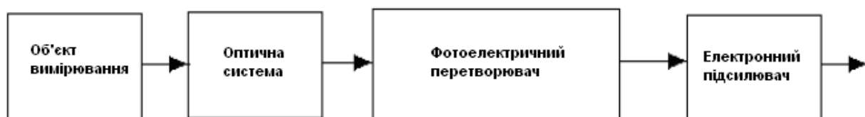
Рисунок 3.16. Структурна схема фотоелектричного пірометра
