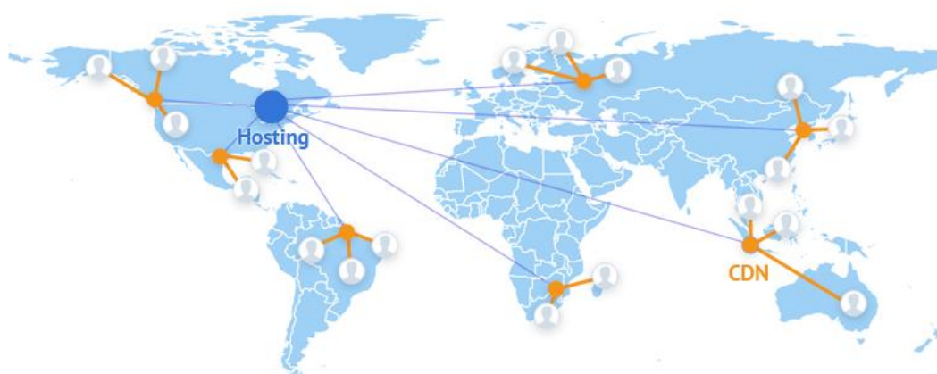
Рисунок 3.6 – Схема дистрибуції контенту від центрального сервера за принципом CDN
