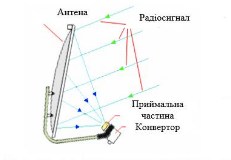
Рисунок 1.4 – Віддзеркалення радіосигналу від антени на конвертор
