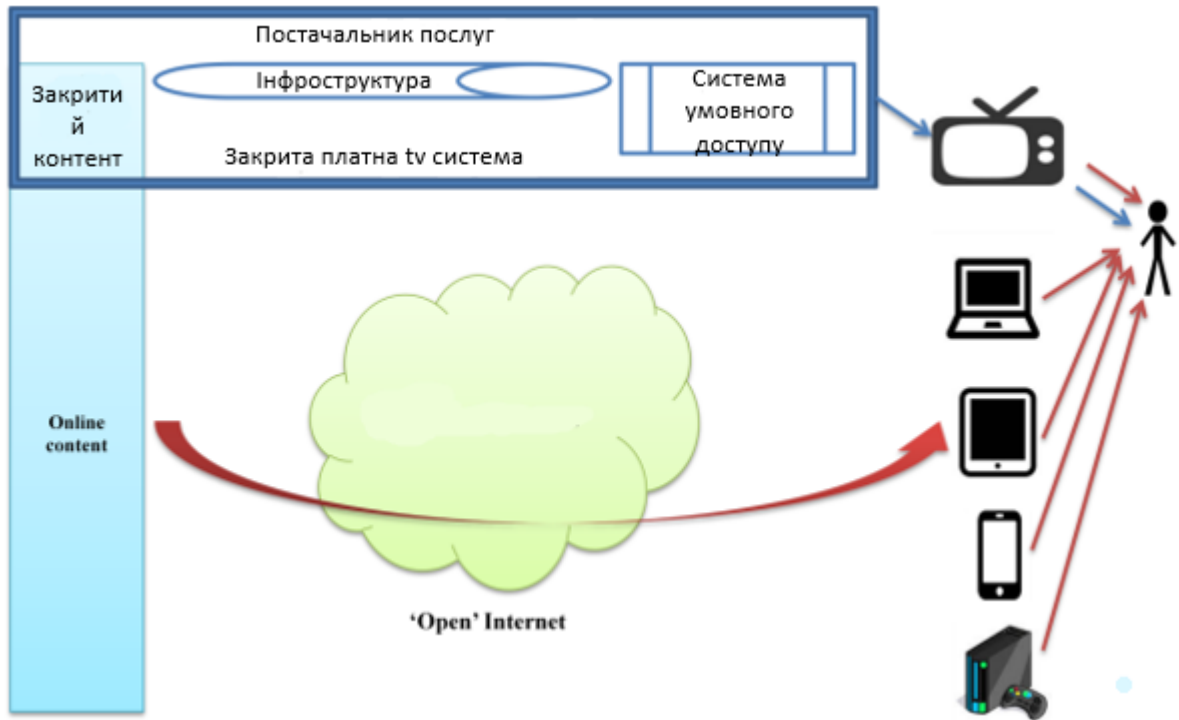
Рисунок 2.6 – Закрита система передавання контенту OTT
