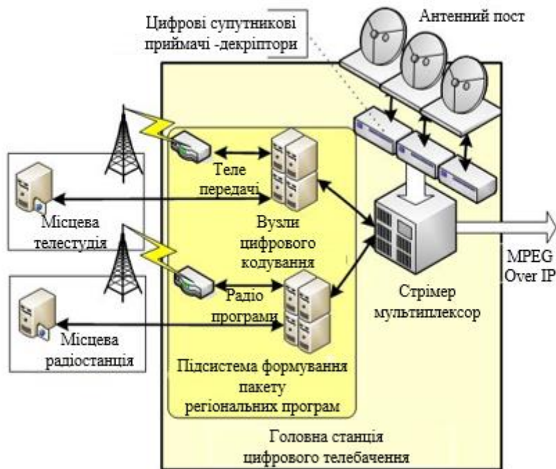
Рисунок 1.12 – Схема головної станції IPTV
