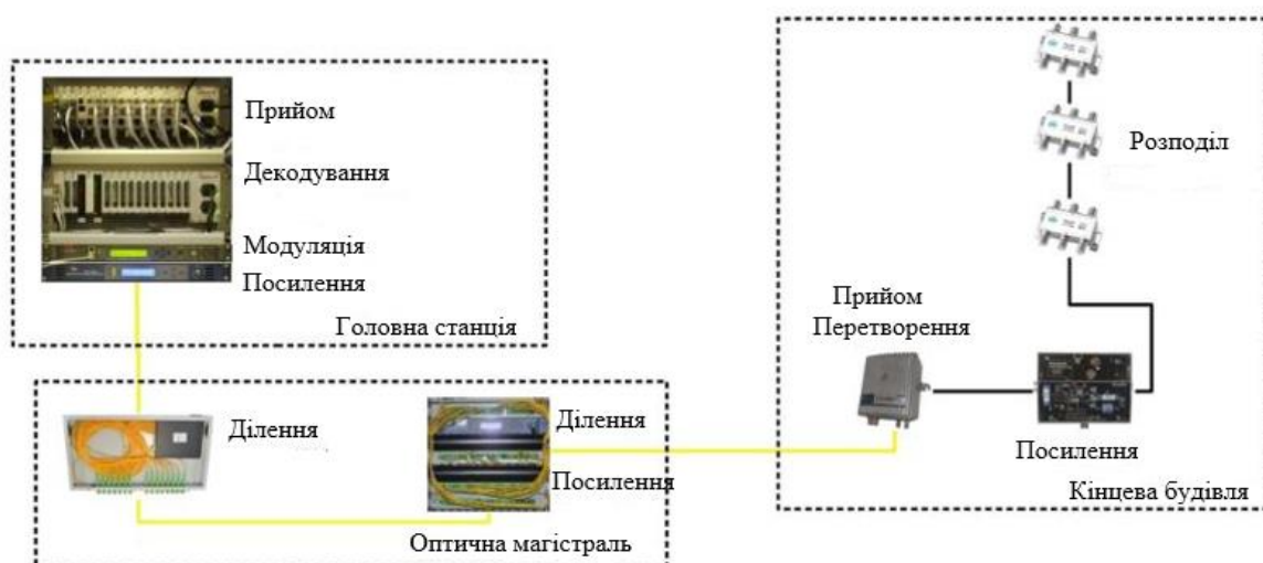
Рисунок 1.7 – Архітектура кабельного телебачення
