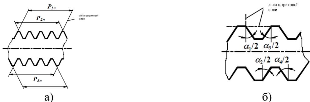
Рис. 4.5. Схема вимірювання кроку (а) та половини кута профілю (б)
