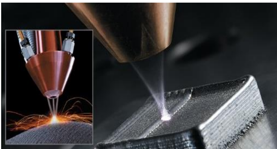
Рисунок 1.8 – Збільшений масштаб процесу пошарового наплення металевого порошку в виробництві деталі за допомогою 3D-принтера [18]
