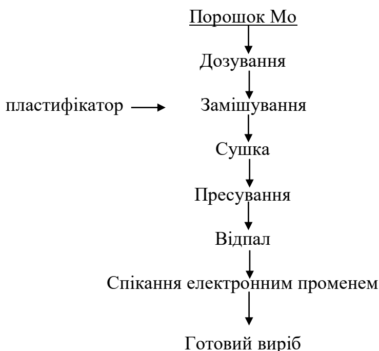
Рисунок 2.1 – Технологічна схема отримання молібдену методом електронно-променевого спікання
