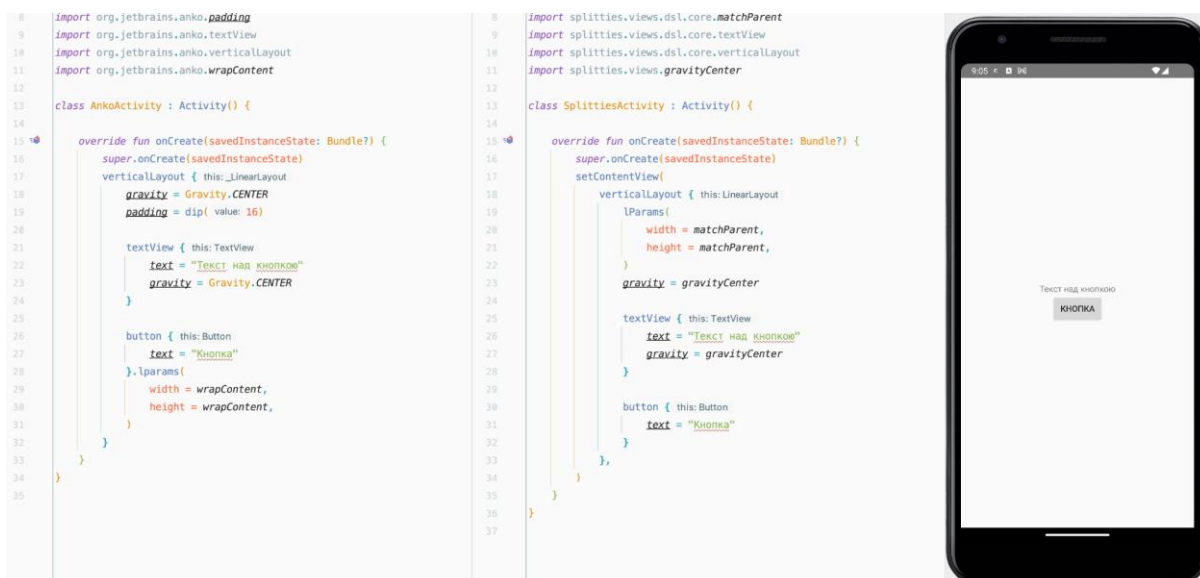
Риснок 3.2 — Приклад створення інтерфейсу користувача за допомогою внутрішньої DSL наданої бібліотеками Anko та Splitties
