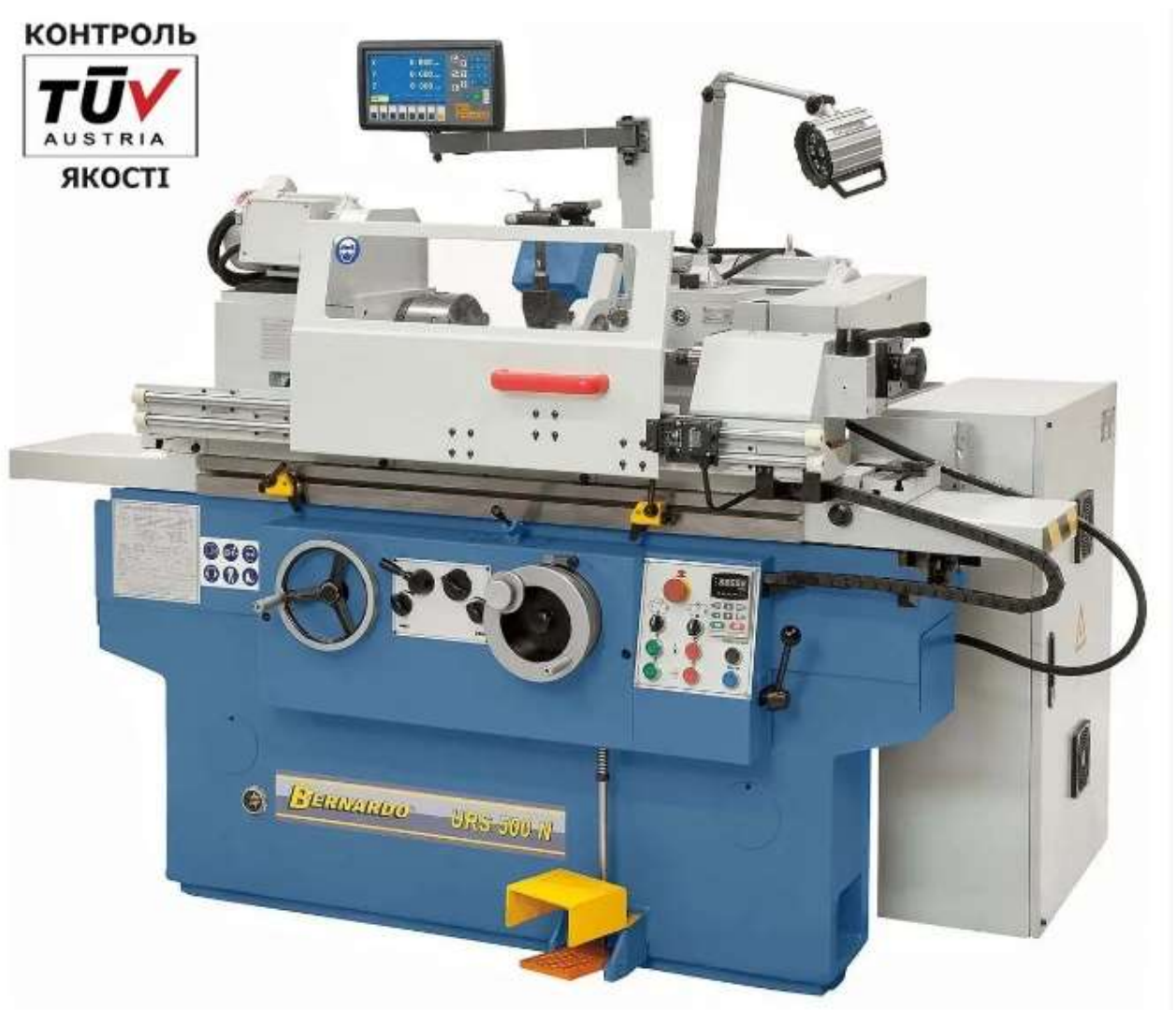
Рисунок 1.8.3 URS 500 N Універсальний круглошліфувальний верстат по металу [4]
