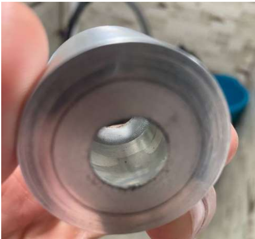
Рис 3.2.1 (в кінці отвору чітко видно дефект обробки)
