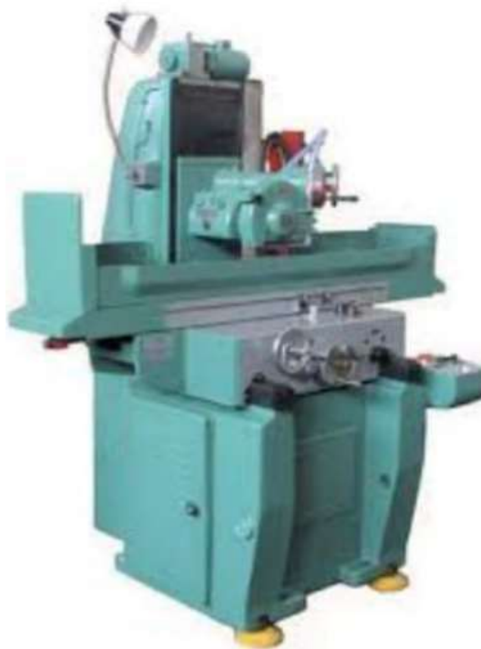
Рисунок 1.8.3 Плоскошліфувальний верстат 3Г71[3]
