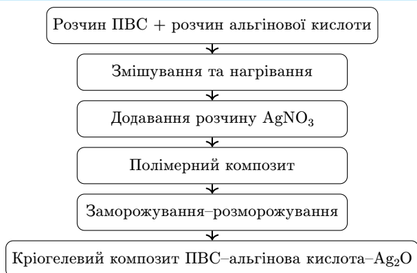
Рис. 1. Схема формування кріогелевих композитів ПВС-альгінова кислота- \text{Ag}_2\text{O} .
