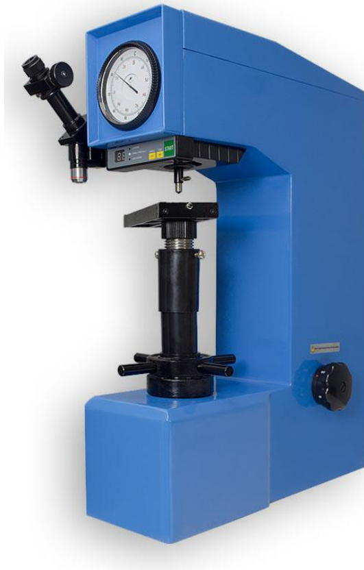
Рисунок 2.2 – Твердомір NOVOTEST TC-БРВ.
