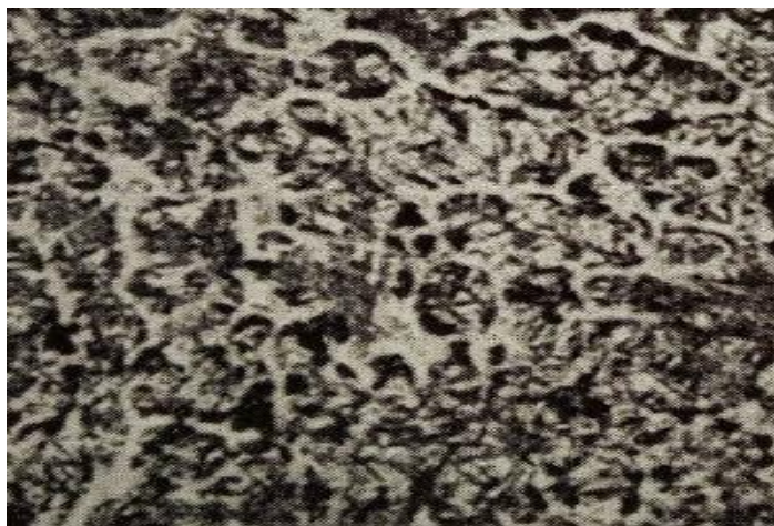
Рисунок 3.2 – Мікроструктура навколошовної ділянки зварного шва (сталь 16ГНМА) x 200
