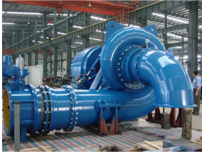
Рисунок 1.9 - Гідротурбінний генератор типу турбіни Френсіс
