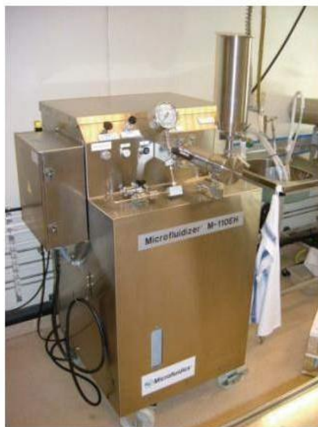
Рисунок 2.3 – Мікрофлюїдаїзер М-110-ЕН і схема пристрою камери взаємодії
