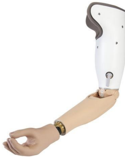
Рис. 1.15. Міоелектричний протез руки [15]
