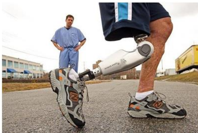
Рисунок 1.25 Електронно-керований колінний модуль POWER KNEE З усіх частин ноги стопу найважче відтворити з точки зору функції.
