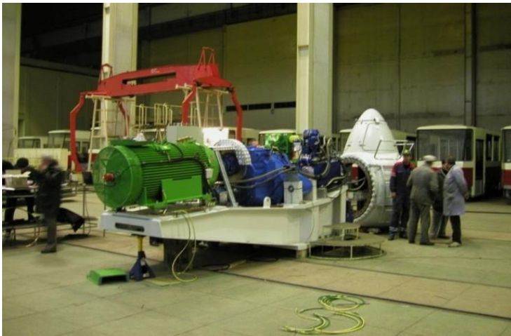
Рис. 2.27. Збирання модуля вітротурбіни Т600-48 на ДП «Виробниче об'єднання Південний машинобудівний завод ім. О.М. Макарова»
