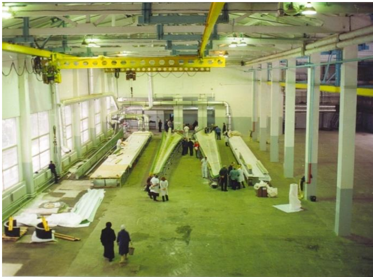
Рис. 2.29. Виробництво лопатей для вітротурбін Т600-48 на ВО «Південний машинобудівний завод ім. О.М. Макарова»
