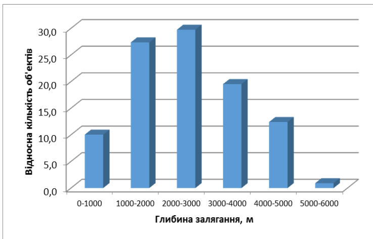
Рис. 6.9. Розподіл глибин залягання продуктивних горизонтів у геотермальних об'єктах з електронної бази даних
