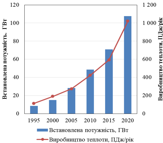
Рис. 6.3. Розвиток геотермальних теплових потужностей і обсягів виробництва теплової енергії в світі за період з 1995 по 2020 роки
