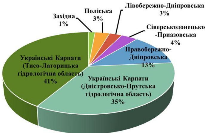
Рис. 5.7. Розподіл технічного гідроенергетичного потенціалу малих річок за гідрологічними зонами
